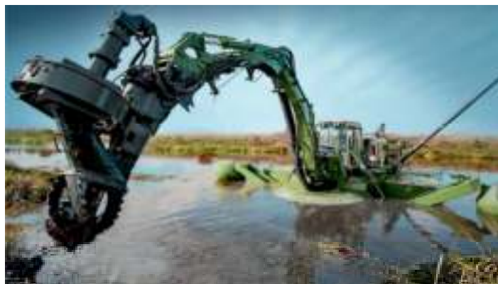
Рисунок 1. Рефулерный земснаряд для очистки водоема
